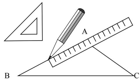
Placer l'un des côtés de l'angle droit de l'équerre le long du côté BA. Déplacer l'équerre le long de BA jusqu'à ce que l'autre côté de l'angle droit arrive en C. Si l'équerre n'est pas suffisamment grande, coller à elle la règle.
