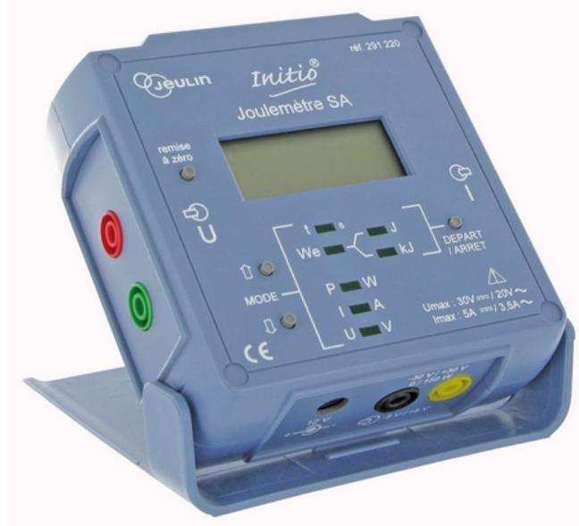
Son branchement nécessite deux circuits. On le branche en série pour mesurer ..... qui la traverse et en dérivation pour mesurer la .....
