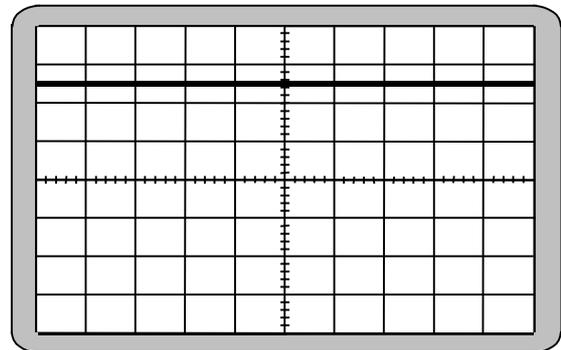
L'oscillogramme est la courbe qui apparaît sur l'écran de l'oscillo. Dans le cas précédent la courbe est une droite horizontale, ce qui signifie que la tension reste constante dans le temps. On dit que le courant est continu.
