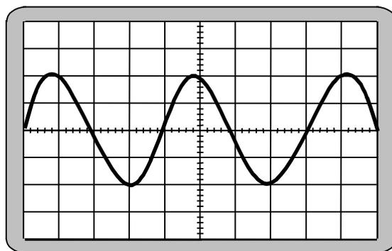
L'oscillogramme est une courbe qui est située tantôt au-dessus de l'axe horizontal tantôt en dessous. Lorsque la courbe est au-dessus, la tension est positive, lorsqu'elle est en dessous, la tension est négative. L'alternat positif et négatif est dû à l'inversion du sens du courant électrique. On dit que le courant est alternatif.
