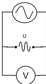
Attention : L'ampèremètre ( non utilisé ici ) et le voltmètre, lorsqu'ils sont montés dans un circuit alternatif, doivent être connectés sur leur sortie alternative.
