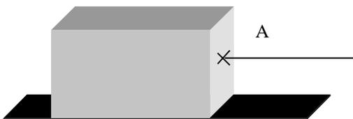
L'action qui provoque le déplacement du bloc est appliquée en un point particulier, le point A, le bloc subit une action ponctuelle.
