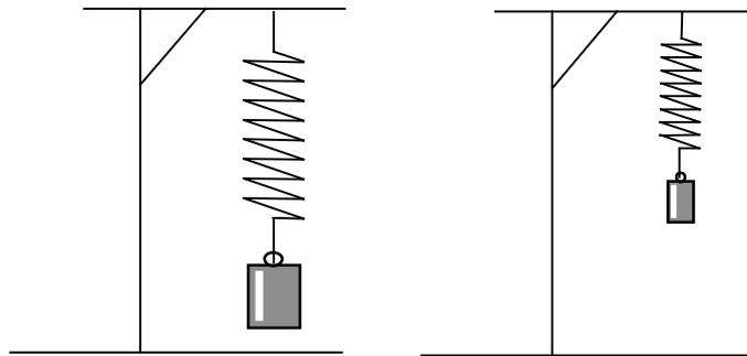
La déformation du 2<sup>nd</sup> ressort est moins importante que celle du 1<sup>er</sup>. La force appliquée sur le 1<sup>er</sup> ressort est plus intense que celle appliquée sur le 2<sup>nd</sup>. La force possède une intensité que l'on pourra mesurer.
