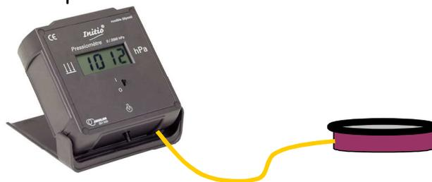
A l'aide d'une balance, on pèse le bécher dans lequel on met du sable de sorte d'obtenir une masse de 25 g. On positionne le bécher sur la capsule manométrique bien au centre, on mesure alors la pression relative obtenue  $P_{rel}$ . On reporte cette valeur dans le tableau.
