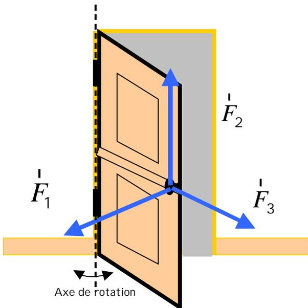
Une porte tourne autour d'un axe de rotation qui passe par les gonds de la porte. Elle est entrouverte et pour l'ouvrir entièrement, on exerce une force. Après plusieurs essais, on constate que seule une des trois forces exercées permet d'ouvrir la porte. La force  $F_1$  permet d'ouvrir la porte alors que les forces  $F_2$  et  $F_3$  ne le permettent pas.
