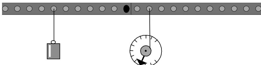
On reporte l'intensité de la force lue sur le dynamomètre et la distance à l'axe.
