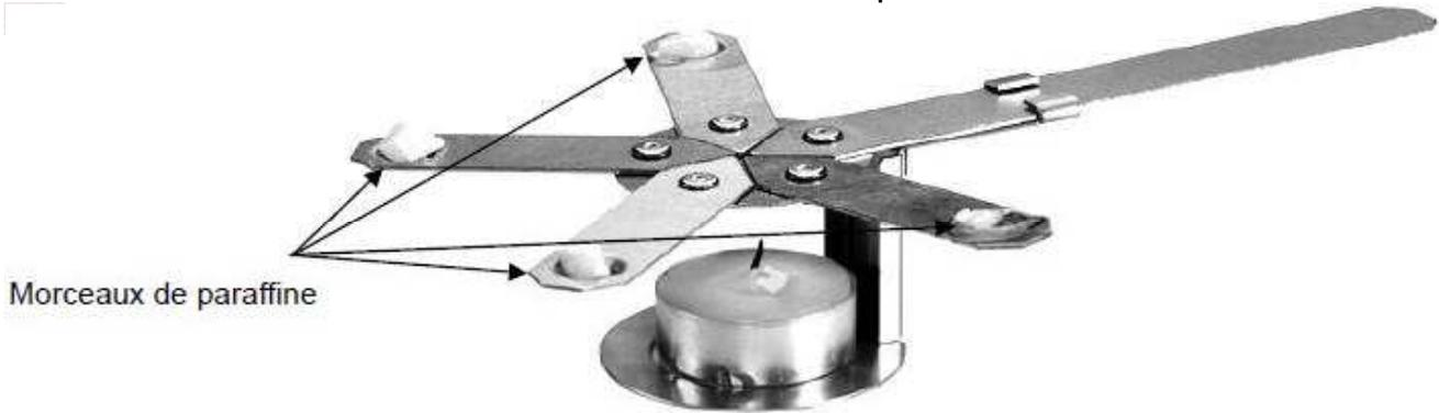
L'expérience consiste à comparer le temps nécessaire à la fusion de la paraffine dans chaque creuset. La paraffine ayant une température de fusion déterminée, son changement d'état permet de savoir à quel moment les extrémités des lames métalliques, au niveau du creuset, atteignent cette température de fusion.
