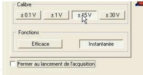
On paramètre le calibre de l'appareil sur 15 V, on en profite pour décocher "Fermer au lancement de l'acquisition" afin de maintenir cette fenêtre ouverte pendant l'expérience.
