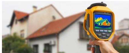
En utilisant des capteurs à infrarouge dans une caméra (on parle de caméra infrarouge ou de caméra thermique), on peut savoir à quelle température est chaque pixel... et donc savoir où une maison "perd" la chaleur du chauffage en hiver...
